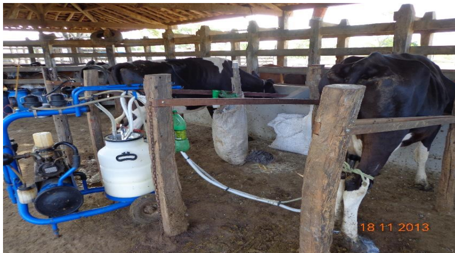
Figura 11. Sistema de ordenha mecânica aberto.
