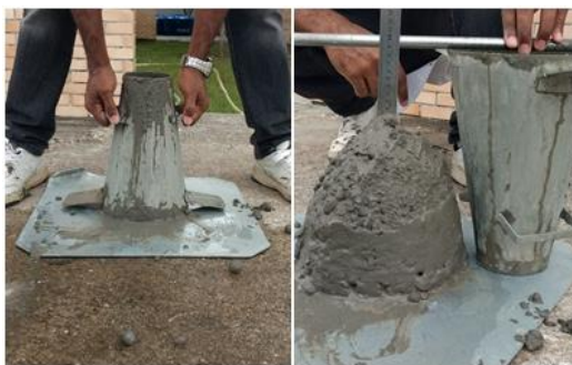
Figura 46 - Ensaio de abatimento do tronco de cone
