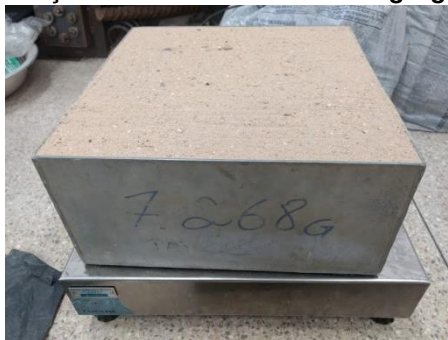
Figura 32 - Determinação da massa unitária do agregado miúdo natural
