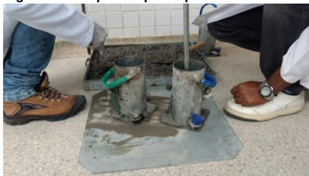
Figura 43 - Moldagem dos corpos de prova pelo método de adensamento manual
