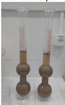
Figura 33 - Determinação da massa específica do agregado miúdo natural
