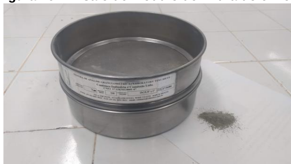
Figura 26 - Ensaio de módulo de finura do cimento
