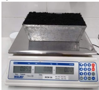
Figura 37 - Determinação da massa unitária do resíduo de borracha de pneu
