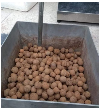
Figura 35 - Determinação da massa unitária da argila expandida
