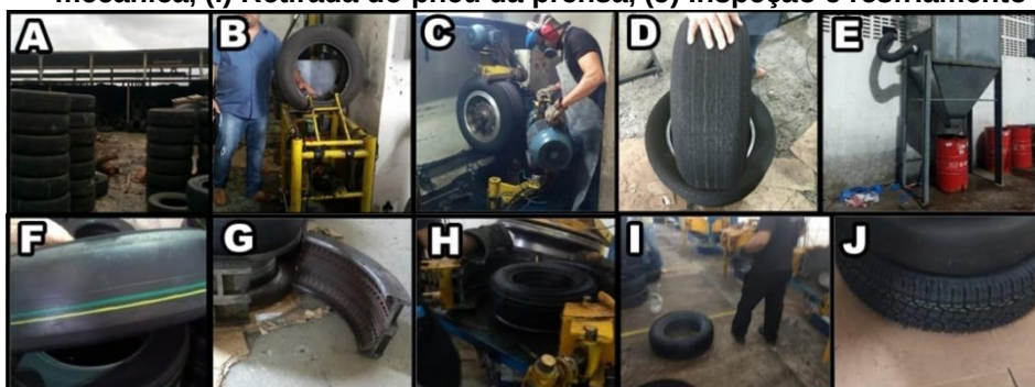
Figura 23 - Processo de recauchutagem do pneu: A) Entrega do pneu, B) Inspeção ou limpeza, C) Raspagem do pneu, D) Pneu raspado, E) Local de armazenamento do resíduo de pneu, F) Aplicação da nova banda de rodagem, G) Forma com desenhos dos sulcos, H) Prensa mecânica, I) Retirada do pneu da prensa, (J) Inspeção e resfriamento
