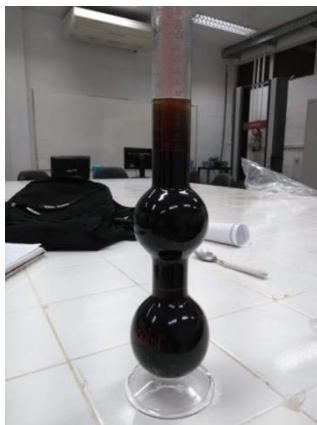
Figura 38 - Determinação da massa específica do resíduo de borracha de pneu
