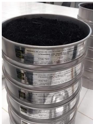
Figura 36 - Determinação da composição granulométrica do resíduo de borracha de pneu
