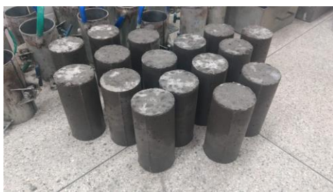
Figura 44 – Desmoldagem dos corpos de prova
