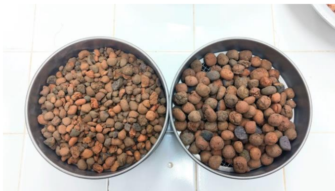
Figura 34 - Ensaio de granulometria das argilas expandidas C1506 (à esquerda) e C2215 (à direita)
