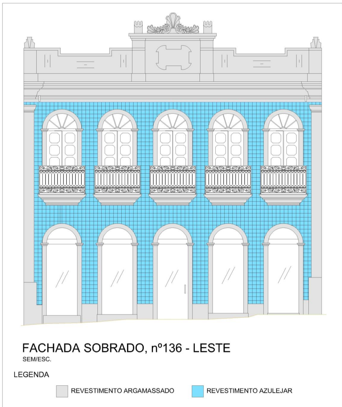
Figura 19 - Representação gráfica da fachada do Sobrado nº136 com seus respectivos revestimentos
