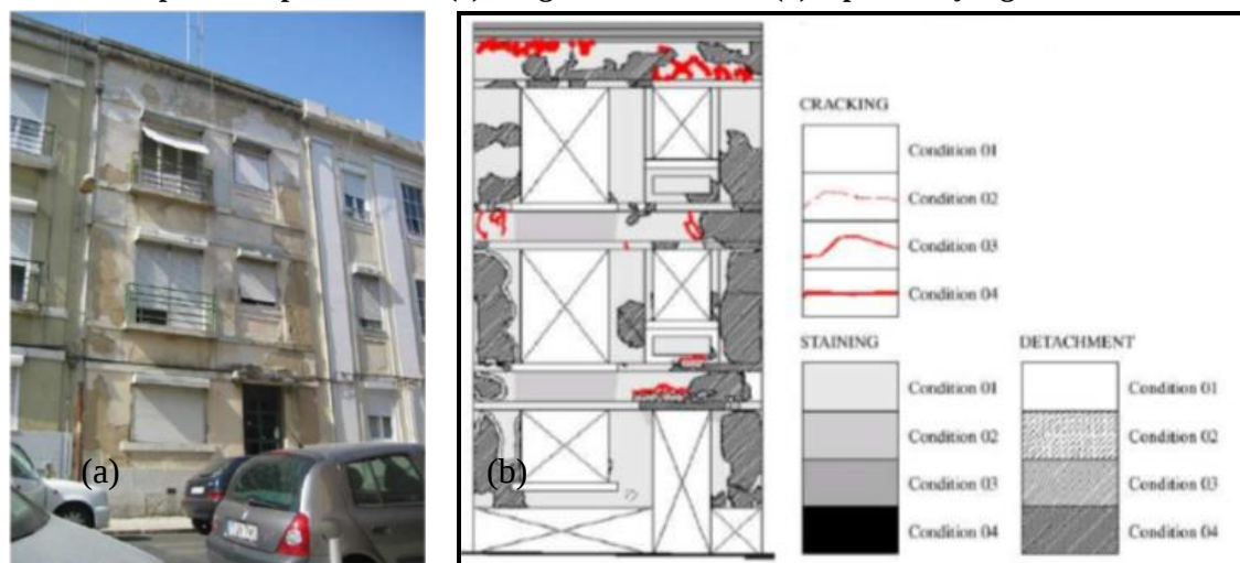
Figura 3 - Exemplo de mapa de danos: (a) fotografia da fachada, (b) representação gráfica dos danos
