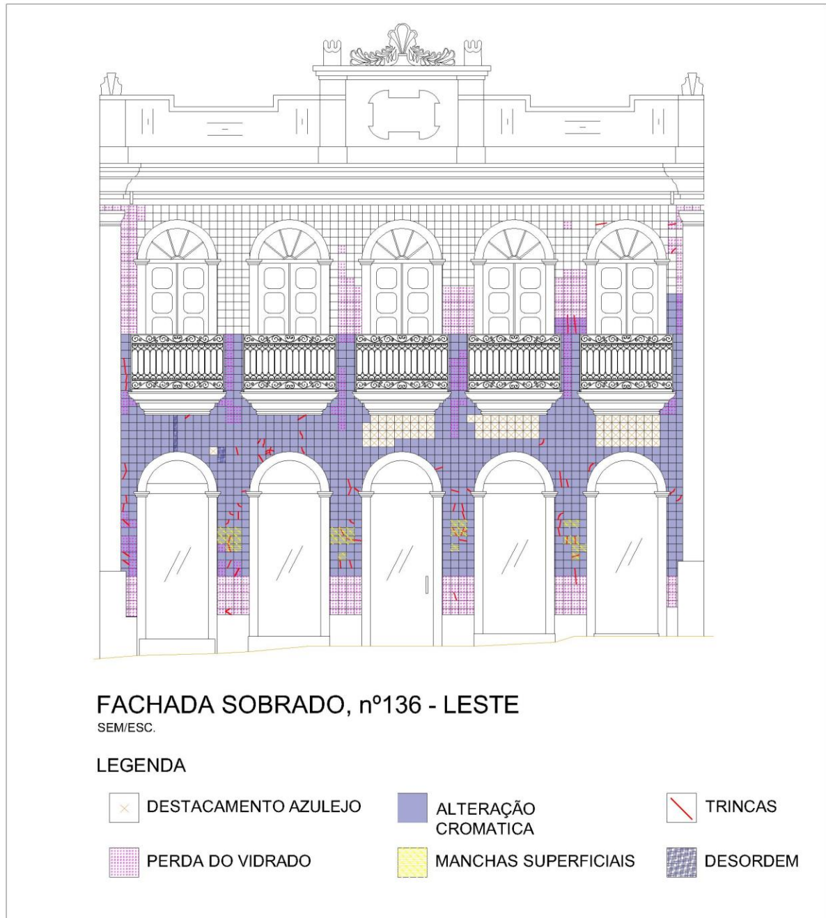
Figura 30 – Representação gráfica do mapa de danos no revestimento azulejar
