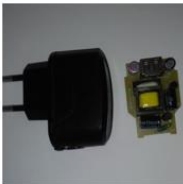
Figura 7: Carregador de celular contendo capacitores
