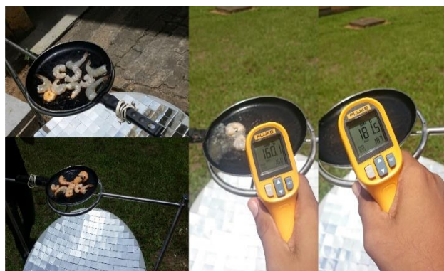
Figura 13: frigideira com camarão, colocada no foco do concentrador solar e o multímetro fazendo a leitura da temperatura na panela.
