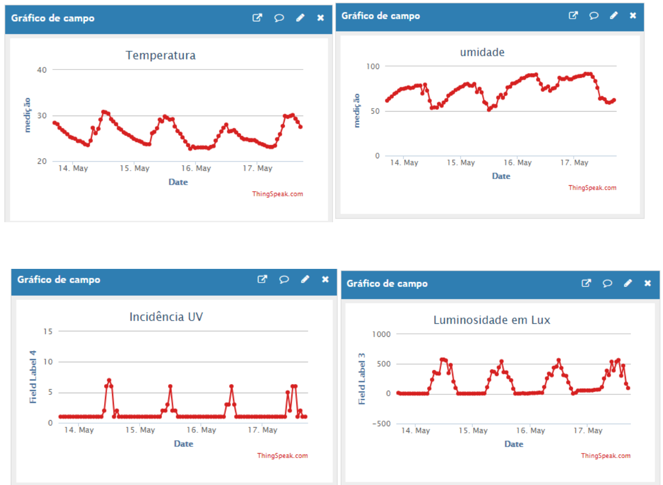
Figura 5- Resultados da estação meteorológica na nuvem do ThingSpeak
