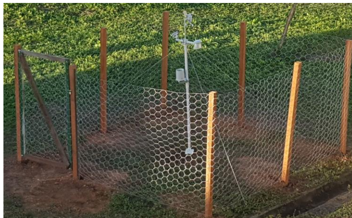
Figura 1- Estação Meteorológica Oregon Scientific - WMR200A instalada no IFS/Lagarto utilizada para validação/homologação dos dados fornecidos para estação projetada
